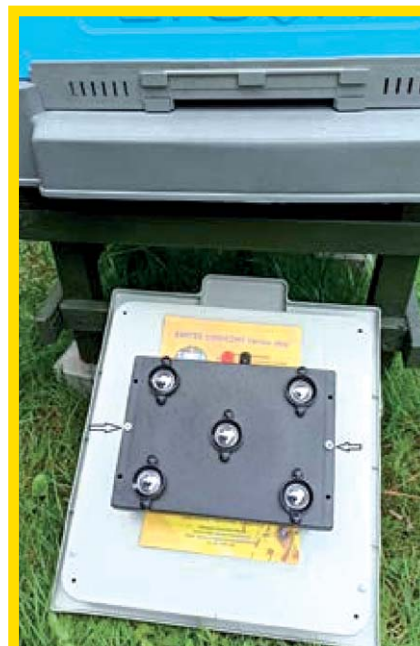
Obr. 12. Spôsob montáže sonického žiariča v zásuvkovom dne veľkopoľského úľa. Žiarič bol pripevnený na spodnú časť zásuvky dvomi skrutkami (označenými šípkami). Poloha žiariča je obrátená, aby bola viditeľná čelná doska.
